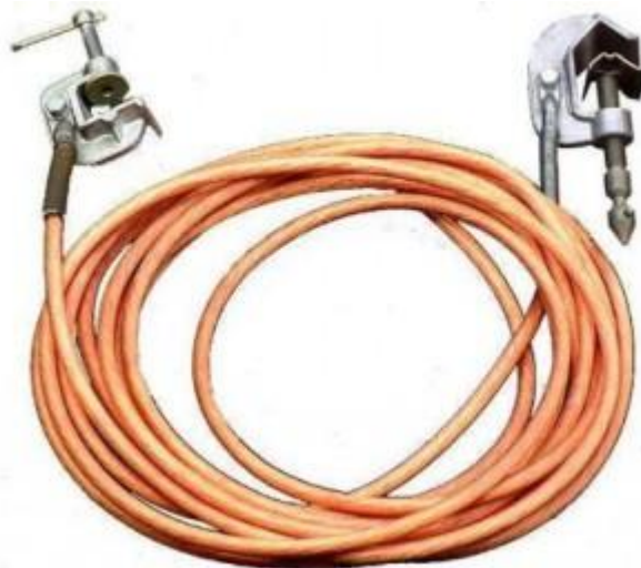
Рис.5. В устройствах переносного заземления используются медные провода без изоляции, так как изоляция может расплавиться при сверхвысоких температурах.
