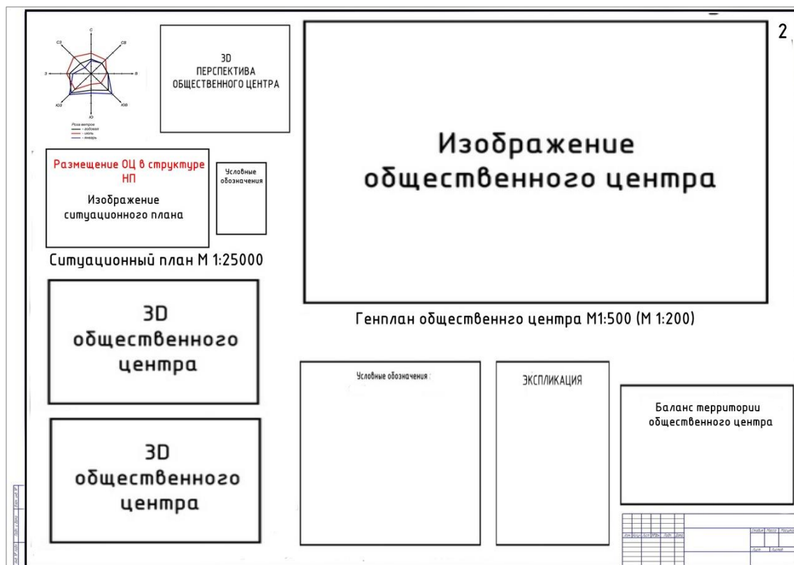
Рисунок 6.4 – Расположение на листе формата А0 или А1 второй части курсового проекта (Розы ветров, ситуационный план (размещение общественного центра в структуре населенного пункта), генплан территории общественного центра, условные обозначения, экспликация, 3D визуализации, перспектива, баланс территории генплана общественного центра)
