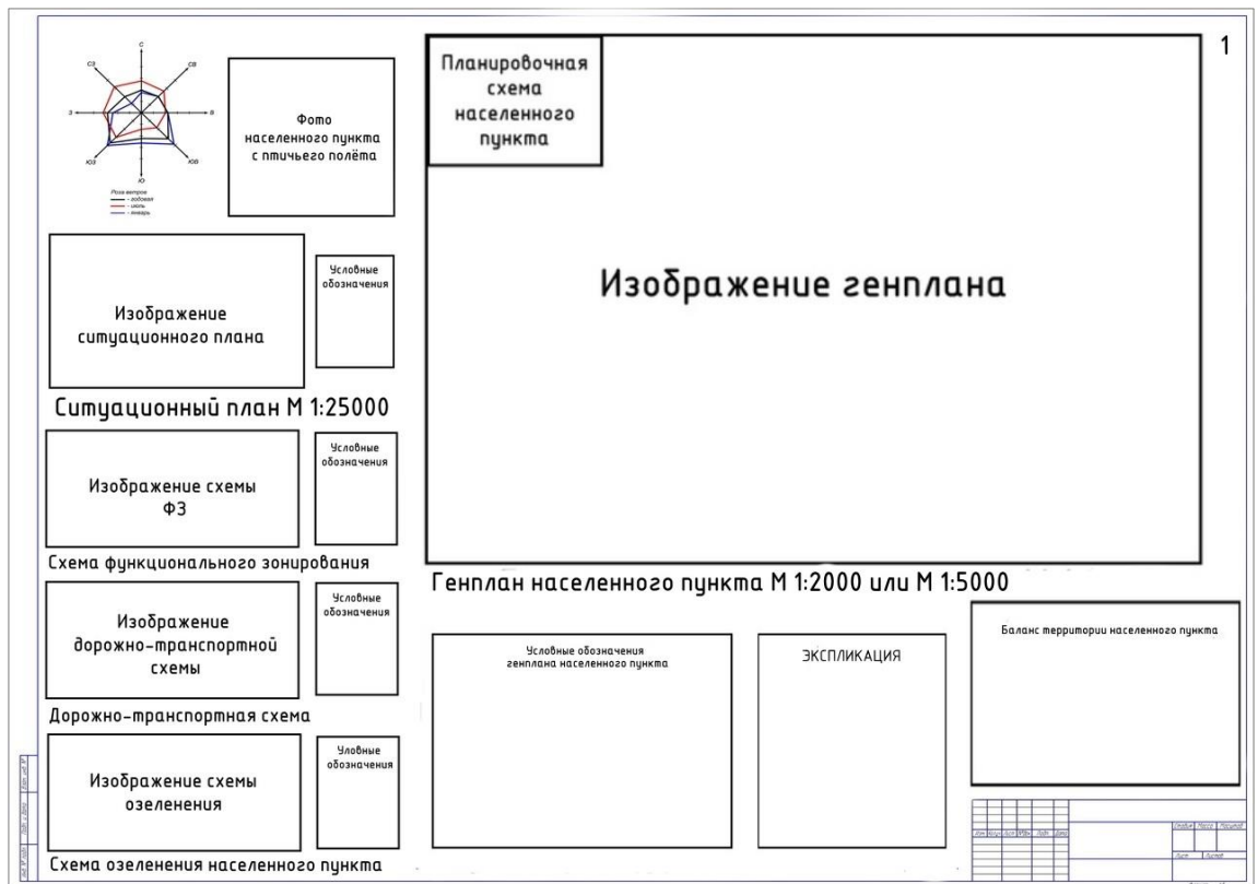
Рисунок 6.3 – Расположение на листе формата А0 или А1 первой части курсового проекта (Розы ветров, ситуационный план, фотография населенного пункта с птичьего полёта, аналитические схемы, условные обозначения, экспликация, генплан населенного пункта, баланс территории генплана населенного пункта)
